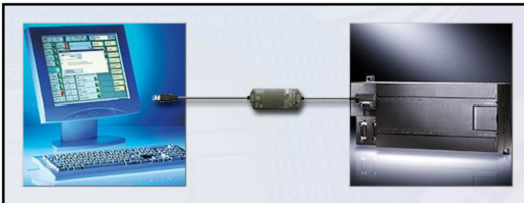
Slika 17. Povezivanje sa računarom 'PPI Multi-Master' kablom sa RS-232 ili USB priključkom.
