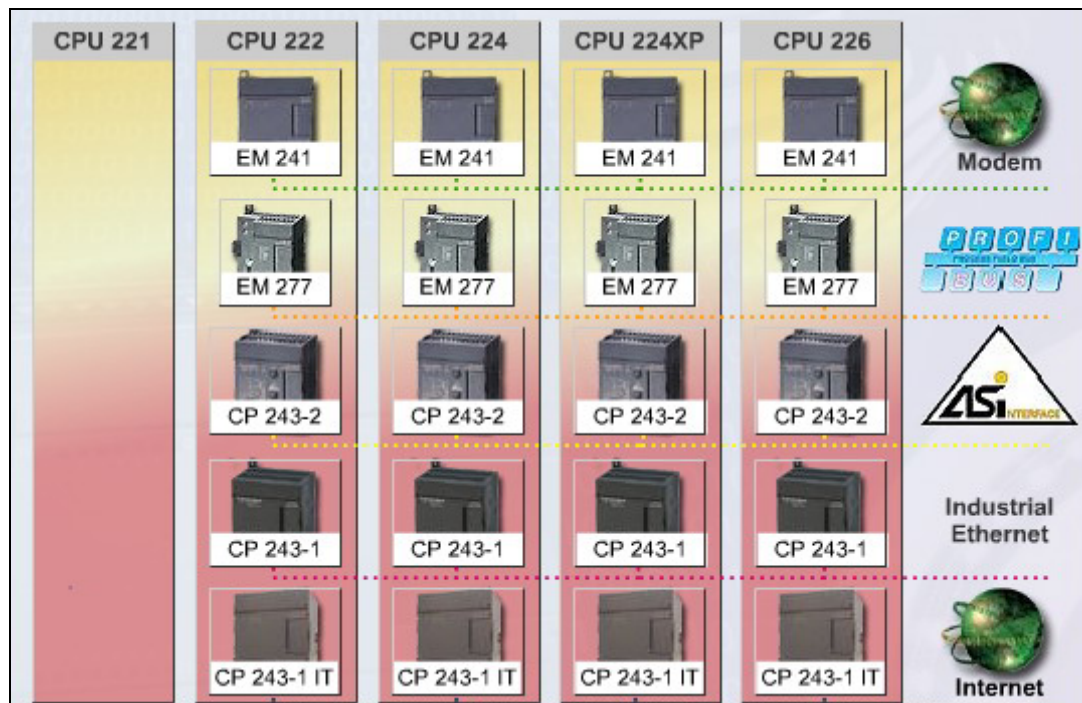
Slika 14. Komunikacioni moduli za proširivanje SIEMENS-ove familije SIMATIC
